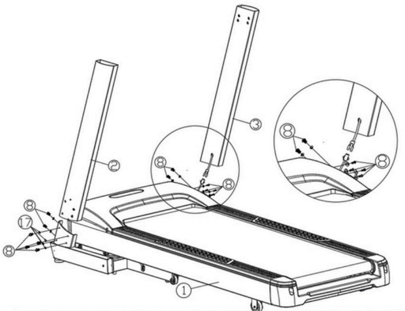
1. Retira el soporte vertical izquierdo (2) y alinéalo con el marco (1). Alinea los orificios para los tornillos, luego utiliza 6 tornillos M8x15 (8) y 6 arandelas planas M8 (17) para instalar el soporte vertical izquierdo al marco usando la llave #5 (11).
