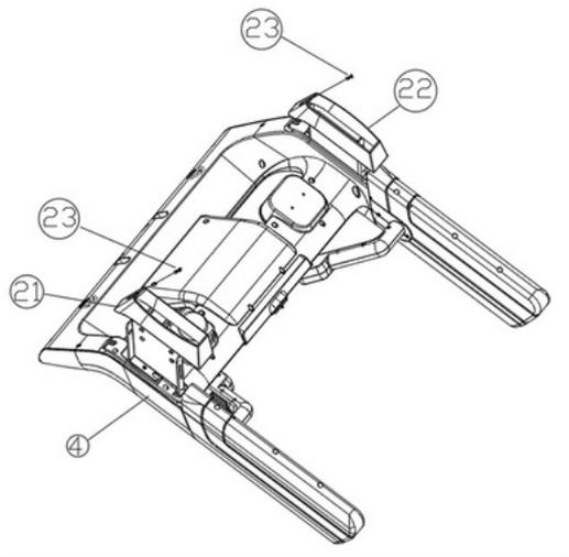
1. Retira la cubierta del soporte vertical derecho (21) y fíjala al soporte de la consola (4) con un tornillo autorroscante de cabeza plana con cruz M4\*12 (23) usando el destornillador (13).
